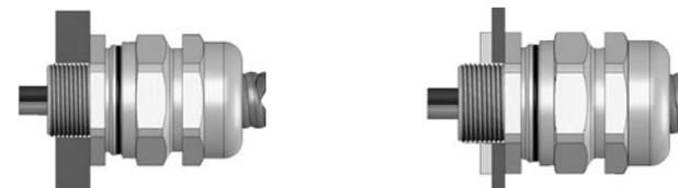
3. Desserrez le corps (4) et l'écrou d'étanchéité extérieur (8) pour détendre le ressort de retenue (5) et le joint de gaine externe (7). (IL N'EST PAS NÉCESSAIRE DE SÉPARER LES COMPOSANTS.)
